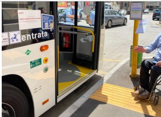
Piazzale Giuseppe Giusti (VI) – esempio di fermata posta in maniera adeguata, con altezza marciapiede corretta (circa 18 cm) e segnaletica tattile di orientamento in corrispondenza di ingresso e palina
