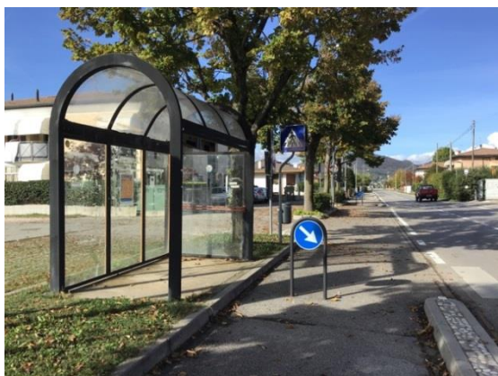
Via Cornaro – fermata del bus con posizionamento inadeguato, altezza insufficiente e mancanza di segnaletica tattile di orientamento
